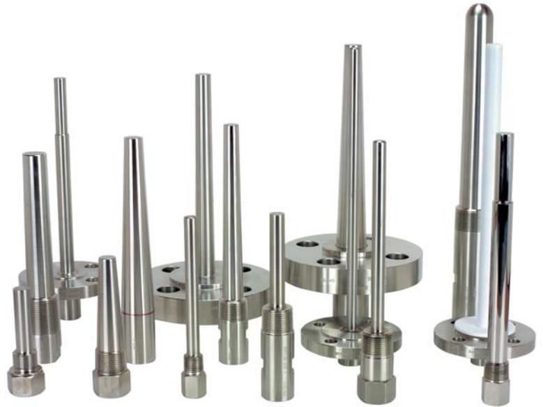
Os poços termométricos são utilizados para proteger a haste do termômetro de efeitos corrosivos, de pressão, da alta velocidade do fluido no processo e para permitir o movimento do termômetro para a recalibração ou da sua substituição, sem interferir no processo.
